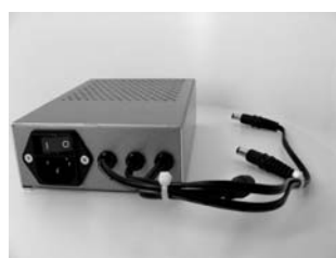
19"-Netzteil zur Versorgung von bis zu 3 DVXi Geräten
